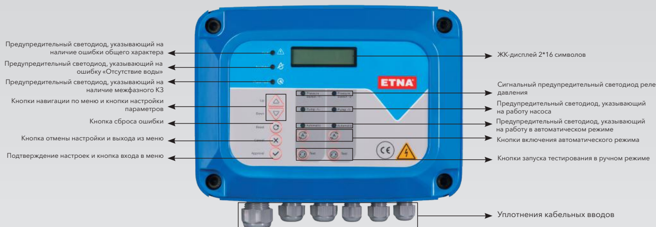
Рисунок 1. Панель управления Hydroman – внешние характеристики
